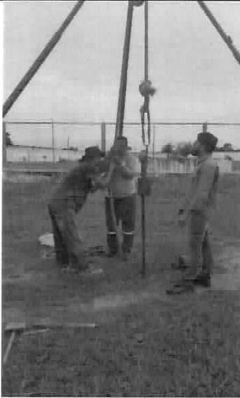
Execução da sondagem 1 - amostra predominante no local ( areia fina pouco argilosa variegada )
