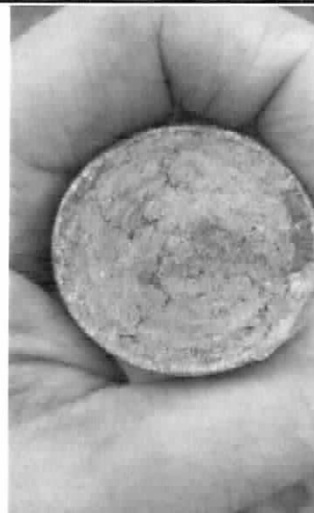
Execução da sondagem 2 - amostra predominante no local ( areia fina pouco argilosa variegada )
